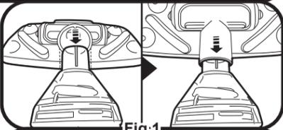
**Nota:** Para piscinas con una baja capacidad de filtración (2,0 m³/h / 530gal/h), o para limpiar esquinas, utilice el boquilla de aspiración plana.
