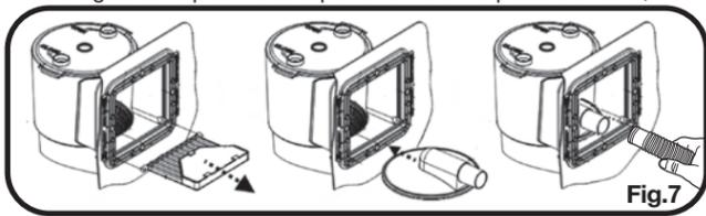
3) Si no tiene skimmer de superficie, el kit incluye 5 tipos de conectores (G1/G2/G3/G4/G5) para los 9 tipos más corrientes de filtros (ver abajo) usados en piscinas autoportantes. Seleccione y coloque el conector correcto de acuerdo al filtro que use su piscina. Apriételo con la mano.
