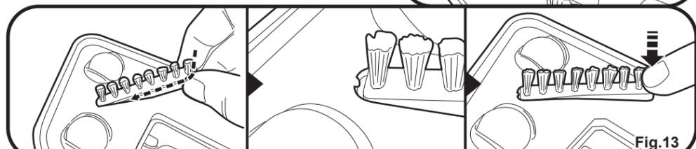
Alinee la curvatura del nuevo cepillo con la ranura del cabezal de succión. Deslice un extremo de la cepillo en la cavidad y bajo el saliente pequeño y luego insertar el otro extremo del cepillo en la cavidad. (Fig.13)
